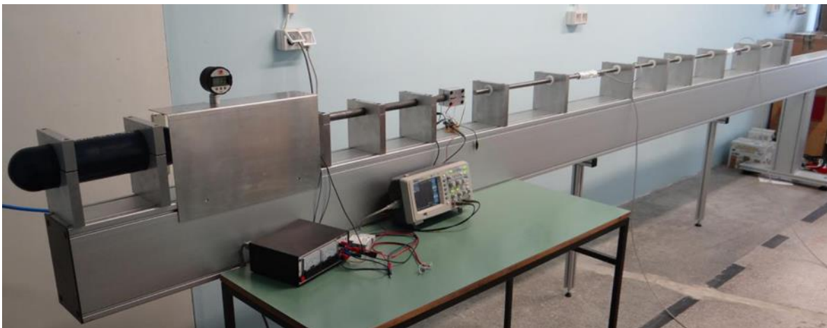
Slika 2: SHPB preizkuševališče na Fakulteti za Strojništvo Univerze v Mariboru [4].
